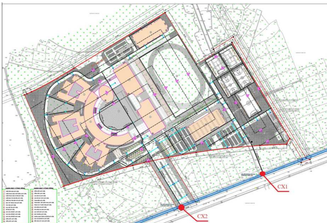
Hình 1. 8. Vị trí thoát nước mưa
